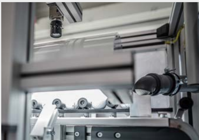
Eine Hochgeschwindigkeitskamera fotografiert die Golfbälle in verschiedenen Positionen.
