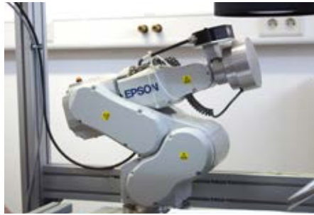
Ein 6-Achs-Roboter mit Magnetgreifer versorgt die Messstation mit Teilen.
