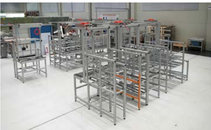
Die U-Form der Anlage erlaubt ein flüssiges, arbeitsteiliges Montieren im Team.
