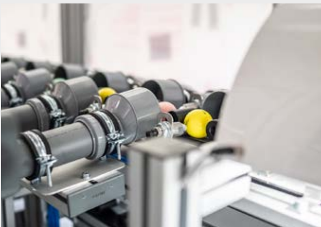
Weitertransport in der Anlage und per Blasedüse ab ins richtige Rohr.
