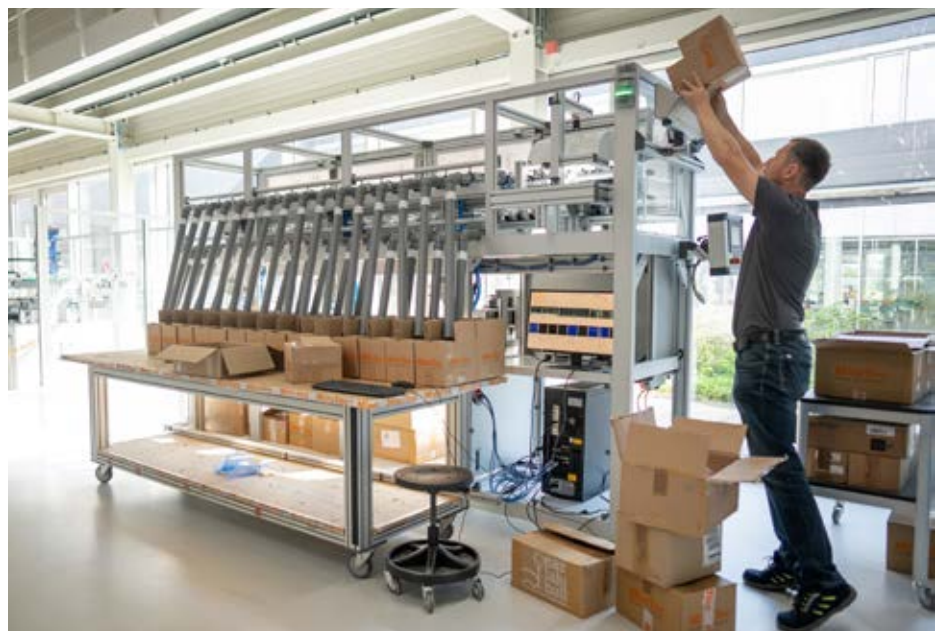
Die Anlage beim Testlauf – ein Mitarbeiter von Meprovision füllt sie mit Golfbällen. Später kommt an dieser Stelle ein automatischer Stufenförderer zum Einsatz.
