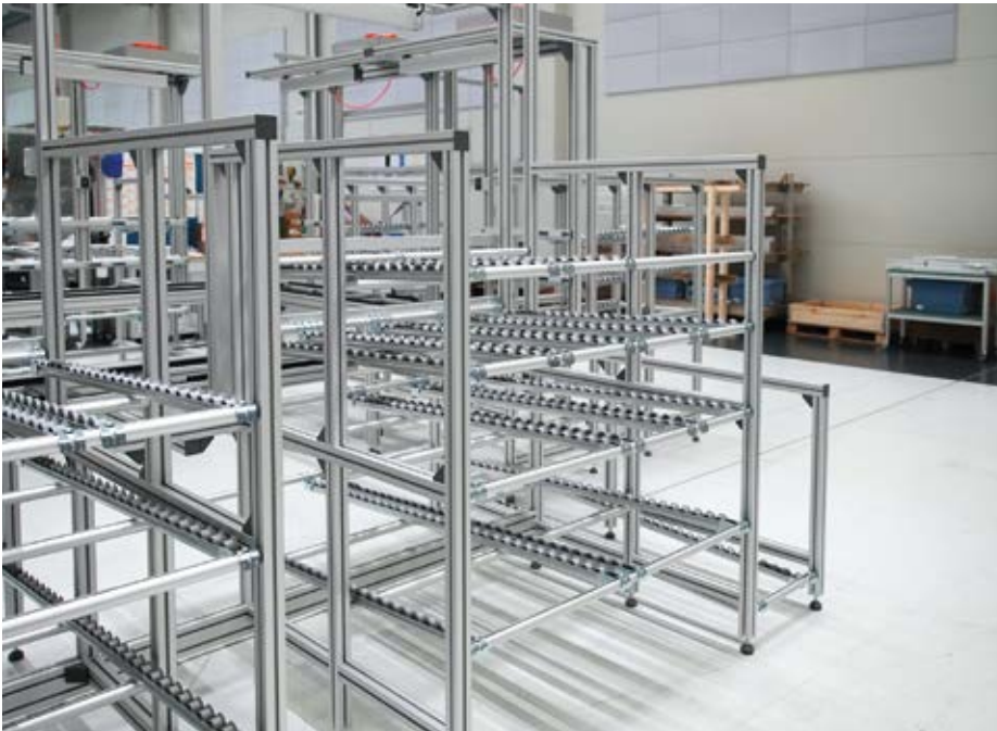
Die Materialversorgung erfolgt via Kanbanbehälter auf Röllchenleisten von der Rückseite der Arbeitsstationen.
